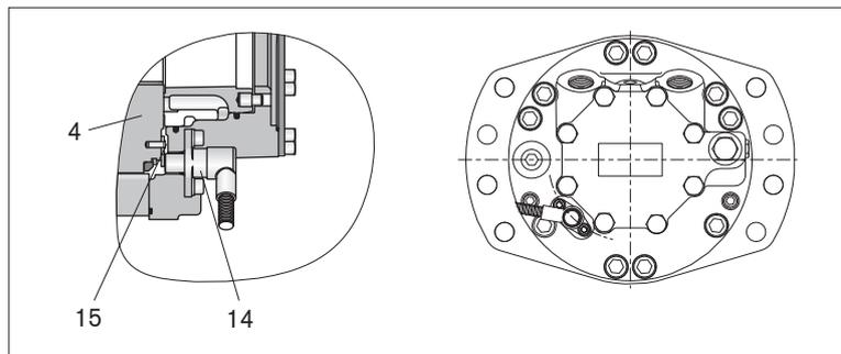
**Fig. 12: Speed sensor**
