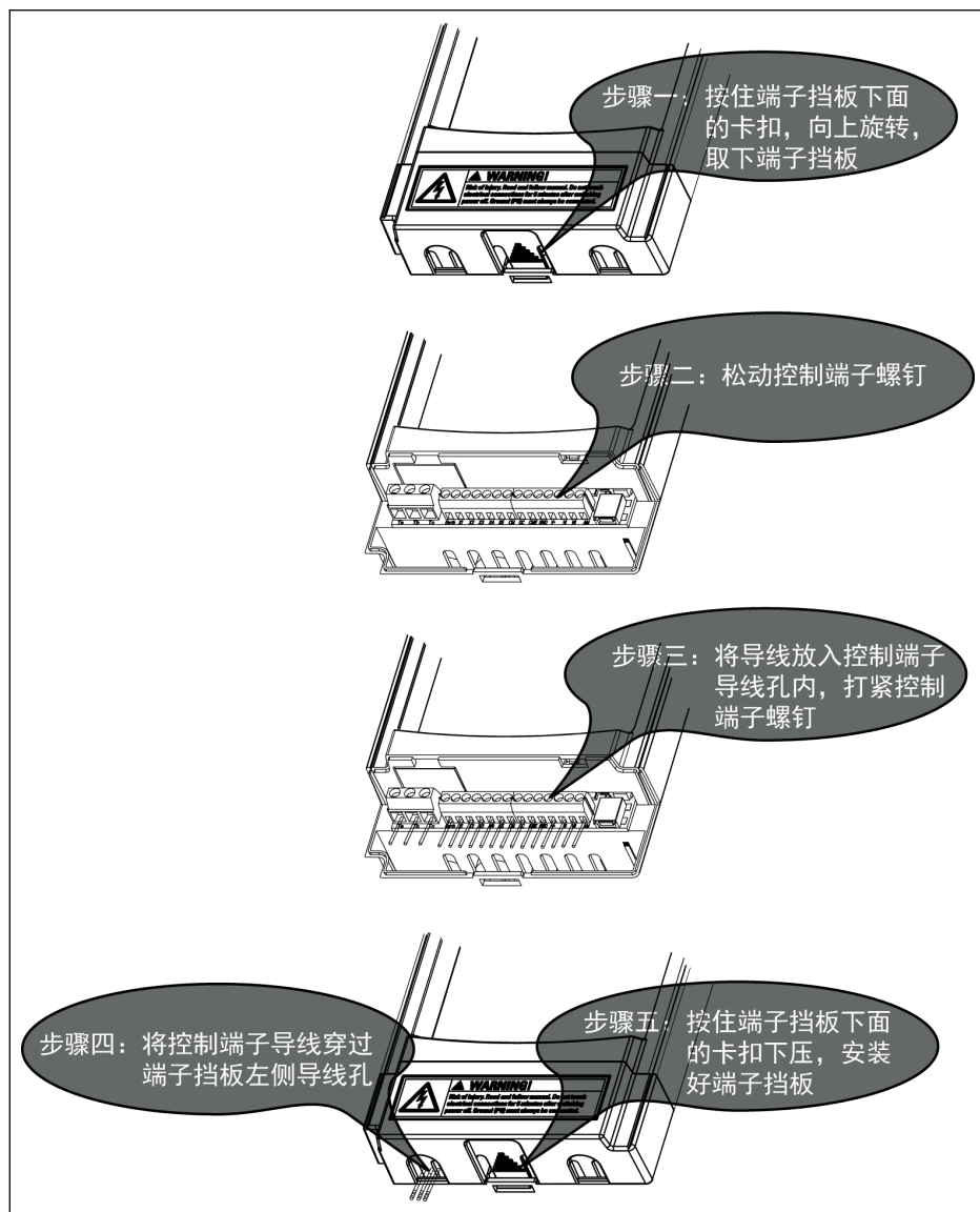
插图 2-10：控制回路配线步骤
